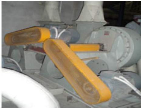
ตัวอย่างแสดงที่ครอบปิดส่วนที่หมุนได้ของเครื่องจักร
