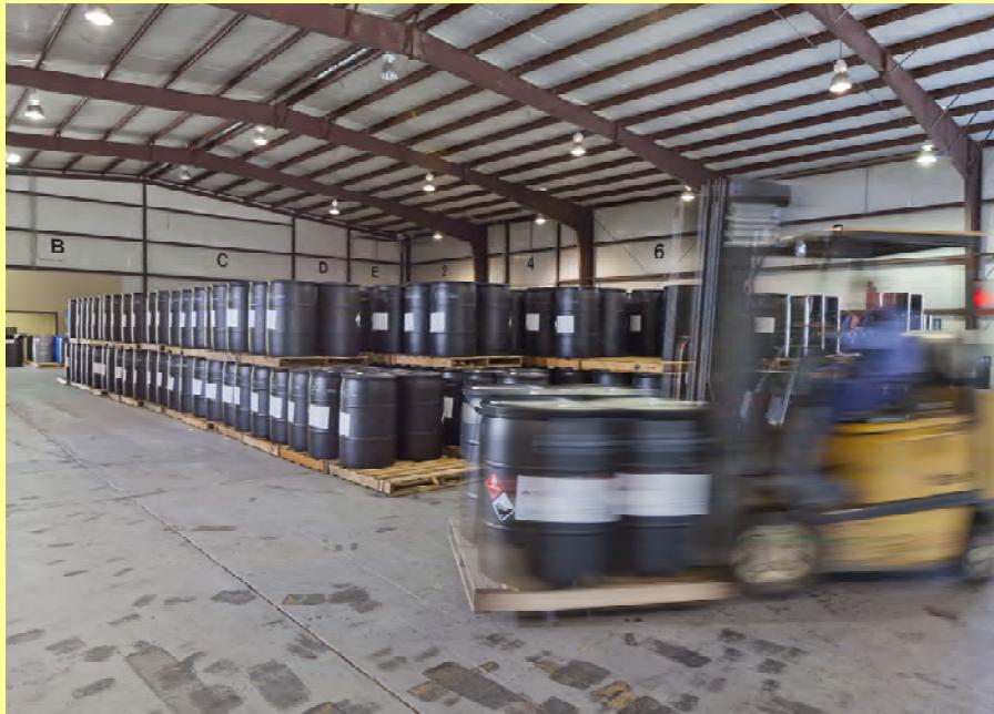
16. อาคารเก็บสารเคมีที่เป็นสารไวไฟ หรือสารระเบิดได้ อุปกรณ์ไฟฟ้าและรถ Forklift ต้องเป็นชนิดป้องกันการระเบิดได้ (Explosion Proof)
