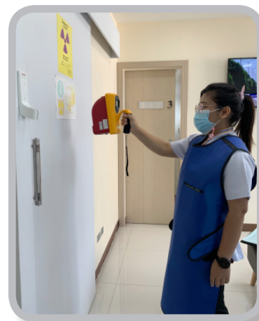
รูปที่ 15 การวัดปริมาณรังสีกระเจิงรอบห้องเอกซเรย์
