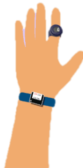
รูปที่ 19 การใช้งานแผ่นวัดรังสีไอเอสแอล ติดที่ข้อมือหรือข้อนิ้ว
