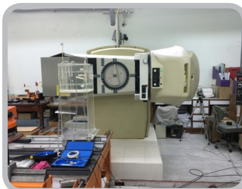
รูปที่ 11 ห้องสอบเทียบเครื่องวัดรังสีด้วยรังสีแกมมาของห้องปฏิบัติการรังสีมาตรฐานทุติยภูมิ (SSDL)
