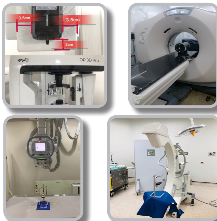
รูปที่ 16 การจัดอุปกรณ์วัดรังสีด้านการตรวจสอบคุณภาพเครื่องเอกซเรย์
